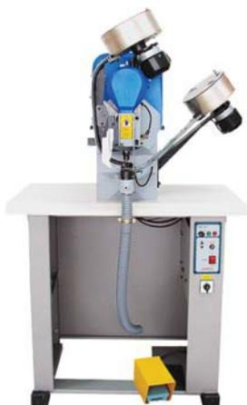
Le sertisseur d'oeillets polycarbonates ou métal électromécanique avec bols d'alimentation automatique.
