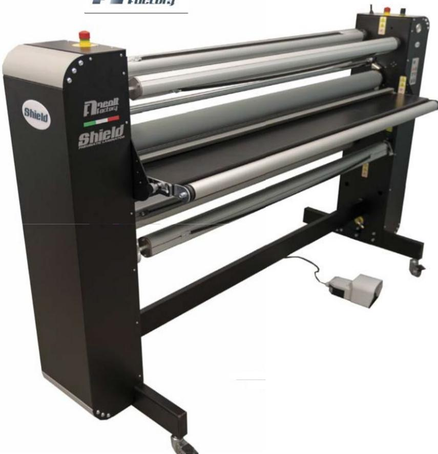
Montée et descente du rouleau à commande pneumatique.
